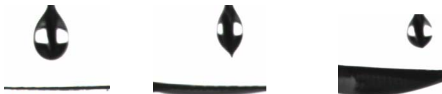
图 7 毛细管中的煤油滴接触覆盖有氧化铅薄膜的铜网前后的照片。
