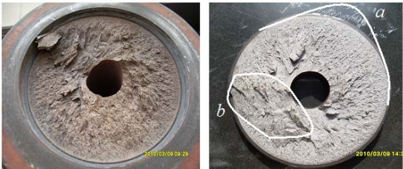
图 1 断裂螺栓断口
