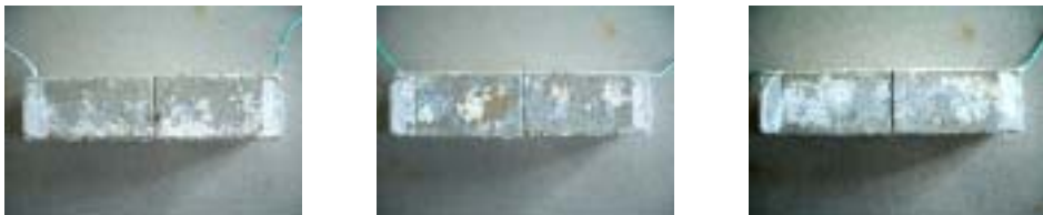
图 4 10d 后试件表面及裂缝的沉积情况
